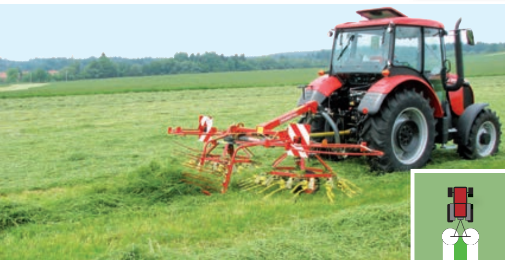
Pradalgių formavimas - virbų sienelės yra darbinėje padėtyje
