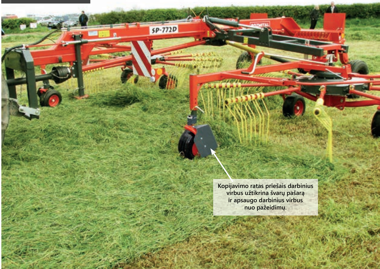
SP - 772D vidurinės pradalgės dviejų rotorių grėblys su laipsniškai reguliuojamu darbinio pločiu
