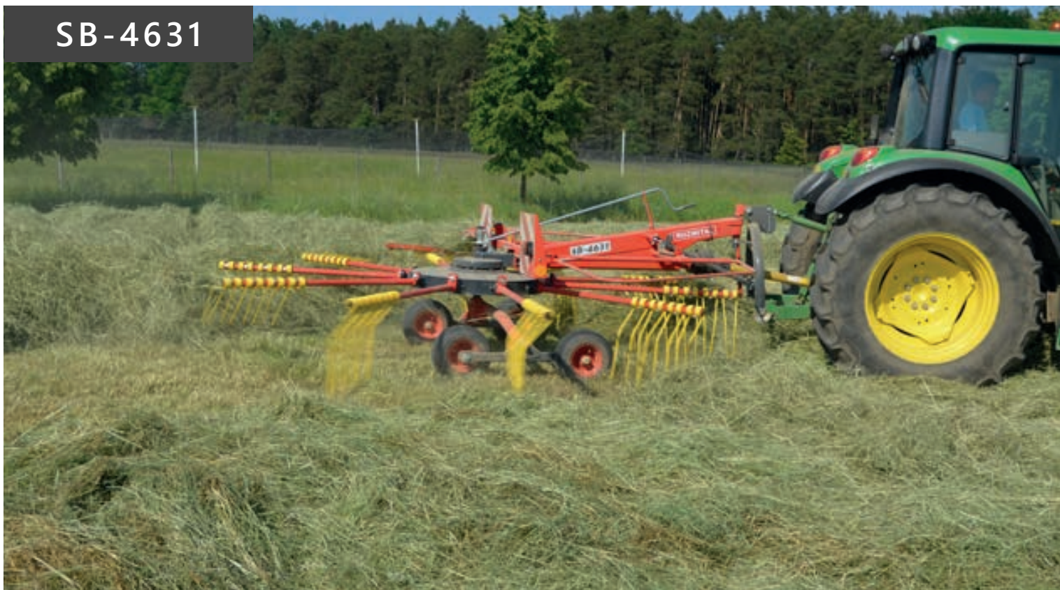
Darbinis plotis 4,60 m. Tandeminė važiuklė su keturiais ratais
