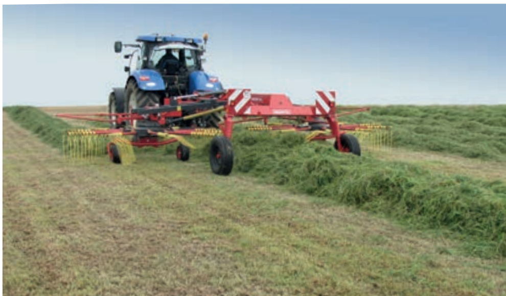
SP - 772D vidurinės pradalgės dviejų rotorių grėblys su laipsniškai reguliuojamu darbinio pločiu
