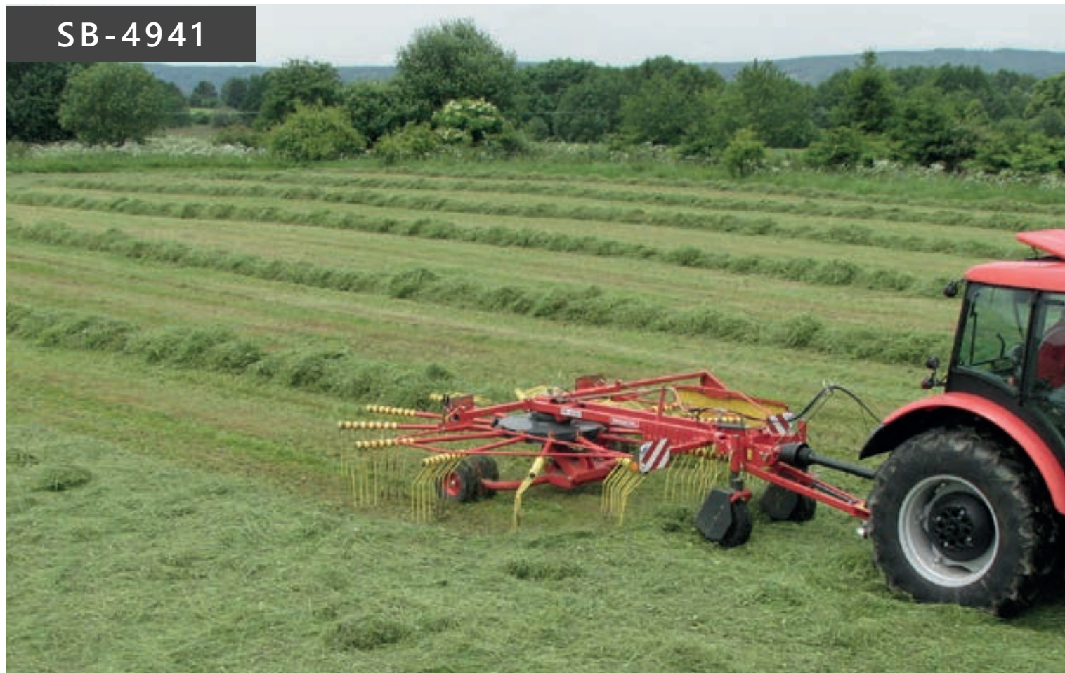
Darbinis plotis 4,90 m. Prikabinamos mašinos, dvigubas tvirtinimas standartinėje komplektacijoje.
