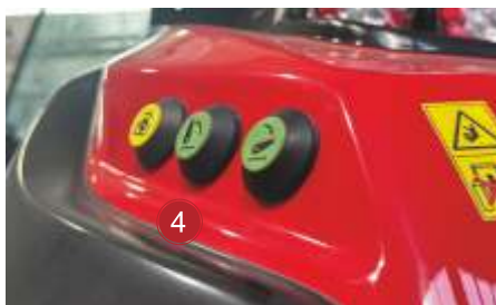
Galiniai hidraulikos ir kardaninio veleno valdymo mygtukai (ant kairio ir dešinio sparno)
