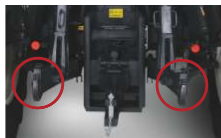
Hidraulinės apatinės jungtys su kabliais
